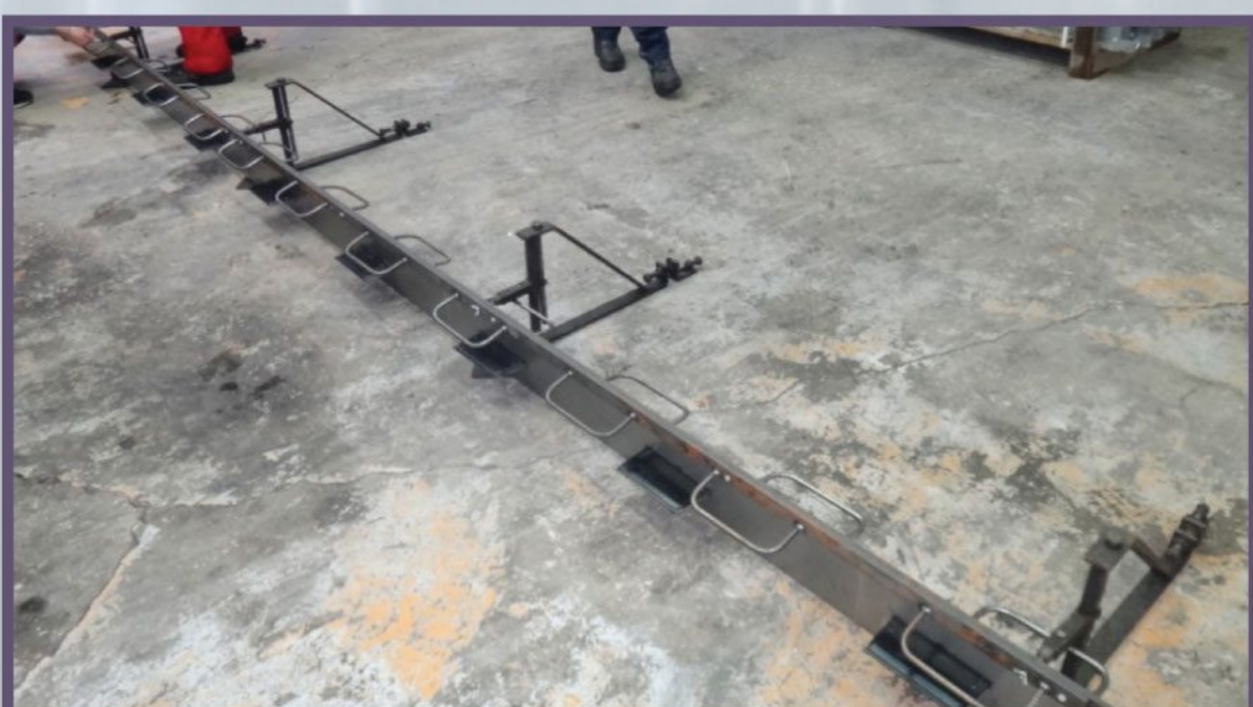
4 Монтаж и крепление фиксаторов должно быть с шагом 1,5 метра. В фиксаторы вставляются штыри из гладкой арматуры диаметром 20 мм (арматурные стержни), которые крепятся в основании. Если необходимо, можно установить дополнительные штыри между фиксаторами. Штыри крепятся к фиксатору при помощи болтового зажима
